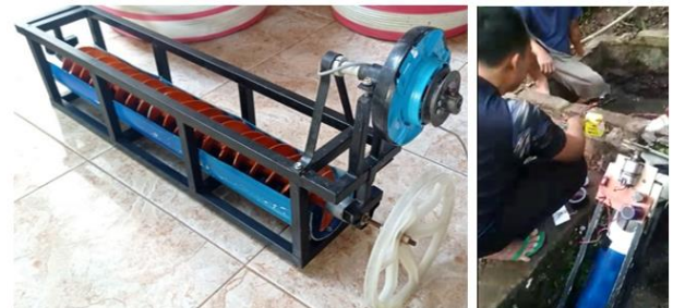
Gambar 7. Uji performansi PLTA skala pico
