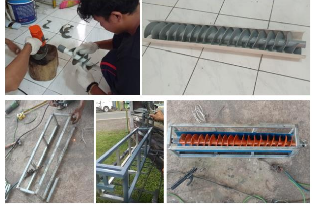
Gambar 6. Fabrikasi peralatan turbin screw
