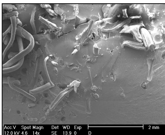
Gambar 6. Mekanisme Pull-out pada Specimen Bending
