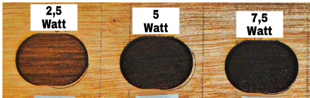
Gambar 3. Tampilan visual sampel setelah pengukiran laser pada berbagai daya laser di kayu meranti
