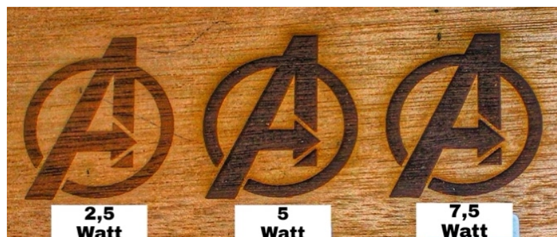
Gambar 7. Tampilan visual hasil pengukiran laser pada preferensi konsumen kayu meranti
