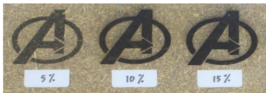
Gambar 7. Produk hasil laser pada papan partikel.
