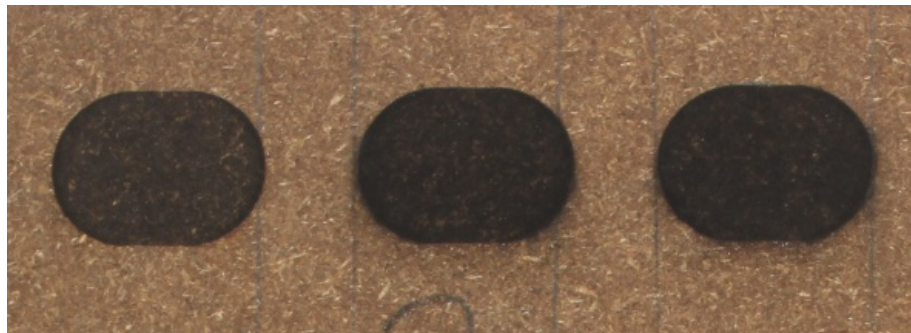
Gambar 3. Perubahan visual papan partikel setelah di laser.
