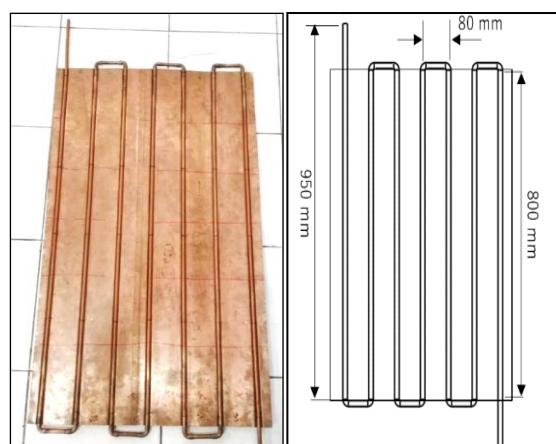
Gambar 1. Geometri kolektor surya dengan *elbow* 90°, *W*=80 mm.
