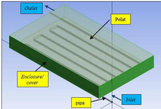
Gambar 2. Desain model kolektor surya (tampak isometri).
