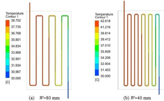
Gambar 14. Perbandingan temperatur fluida keluar berdasarkan jarak antara pipa (*W*)
