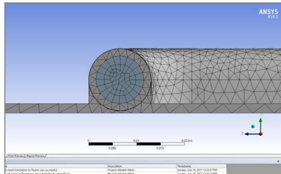
Gambar 5. Hasil meshing pipa bagian luar.
