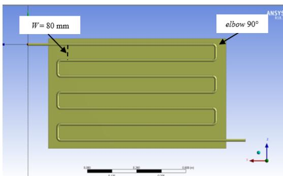
Gambar 3. Desain model kolektor surya (tampak atas).
