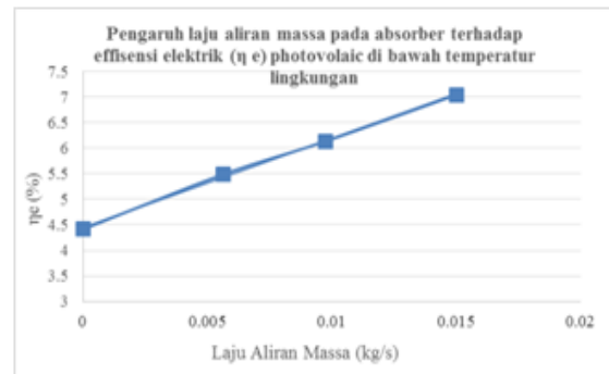
Gambar 4. Pengaruh laju aliran massa terhadap efisiensi listrik PV/T pada temperatur fluida masuk di bawah temperatur lingkungan
