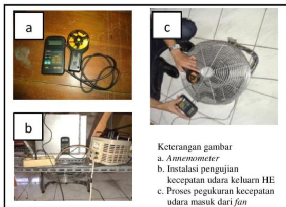
Gambar 5. Proses pengukuran laju aliran udara
