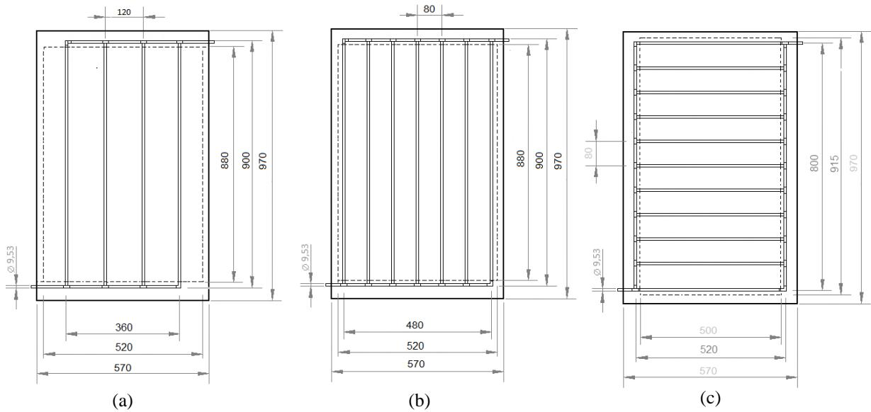
Gambar 1.Rancangan Kolektor (a) <sup>3</sup> W/D=12 Vertikal, (b) W/D=8 Vertikal dan (c) W/D=8 Horizontal.
