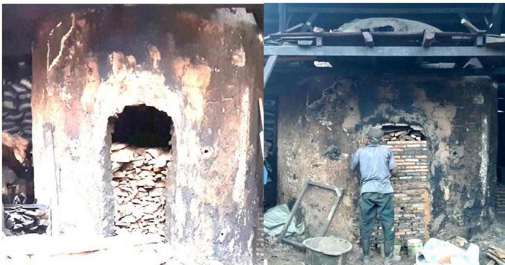
Gambar 2. Bentuk tungku kubah pembuatan arang hayati.
