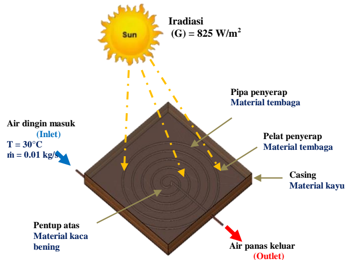
Gambar 4. Pemodelan kondisi batas dan jenis material kolektor surya.
