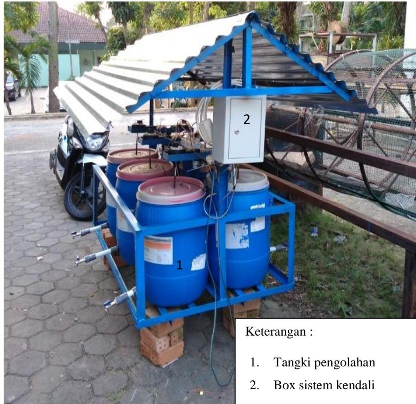
**Gambar 1. Rancangan bangun sistem pengolah limbah otomatis**
