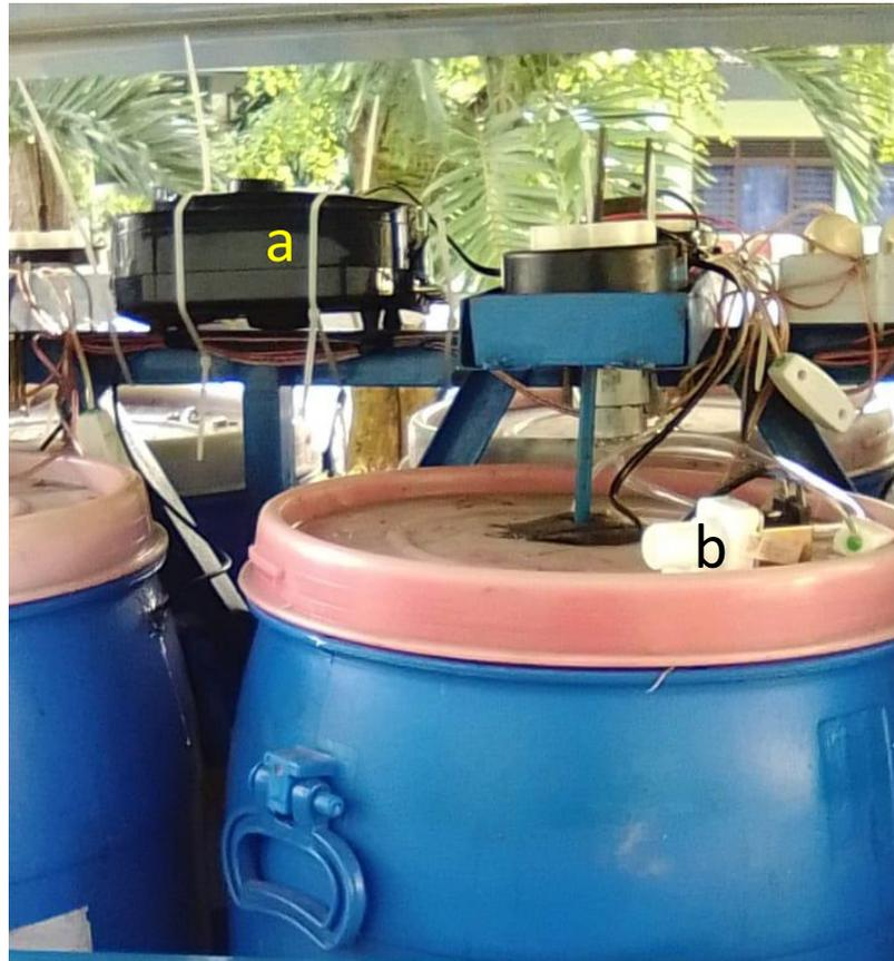
**Gambar 6. Aktuator pompa udara (a) dan aktuator keran udara (b)**
