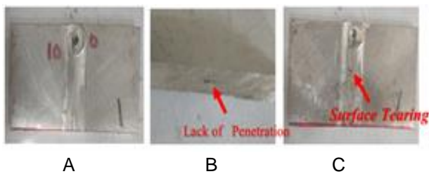
Gambar 4. Hasil penyambungan DFSW kedalaman las 1,6 mm. a. permukaan atas, b. penampang melintang, c. permukaan bawah Indentor
