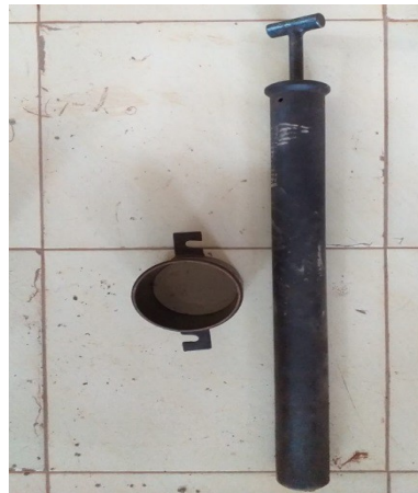
Gambar 1. Alat Uji Pemadatan Modifikasi
