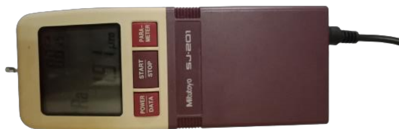
Gambar 14. Alat uji kekasaran permukaan.
