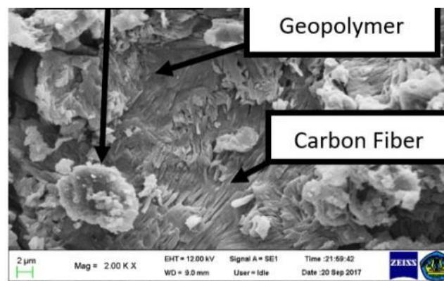
**Gambar 15.** Hasil uji SEM untuk spesimen 3 (S0, CF 15%)
