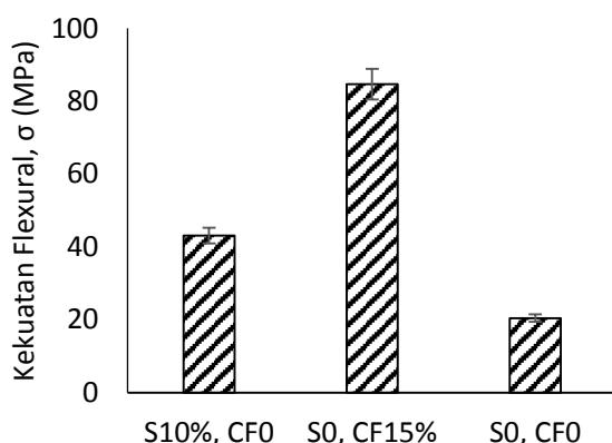
**Gambar 12.** Kekuatan Flexural
