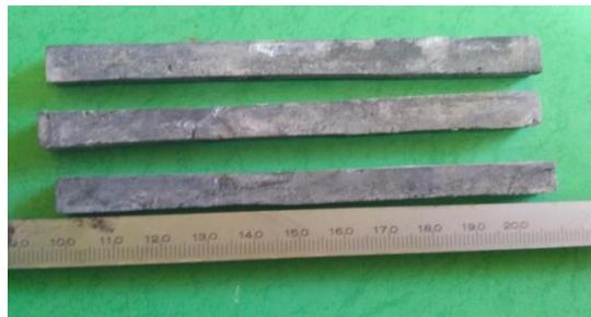
**Gambar 3.** Spesimen uji bending
