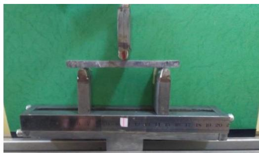
Gambar 9. Alat uji bending
