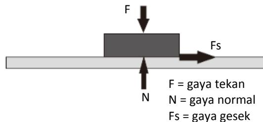
**Gambar 6.** Gaya-gaya pada model pengujian pin on disc
