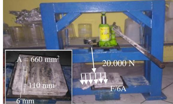
**Gambar 2.** Alat cetak spesimen bertekanan
