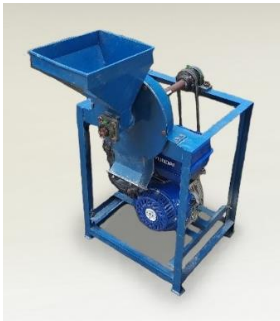
Gambar 4. Mesin penggiling sekam padi.
