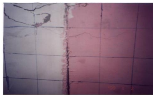
Gambar 8. Belahan pada batas sambungan
