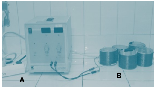
Gambar 1. Rangkaian sumber medan magnet. A. power supply, B. solenoida. Benih yang diberi perlakuan diletakkan pada petridish yang kemudian diletakkan di atas solenoida.
