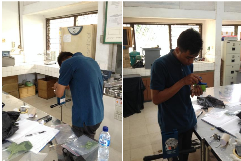
Gambar 12. Proses pengukuran leaf water potential (LWP) pada tanaman melon menggunakan alat PMS Instrument Model 600.
