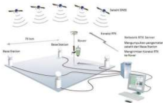
Gambar 2. Sistem Kerja NRTK (Sumber: BPN, 2011)
