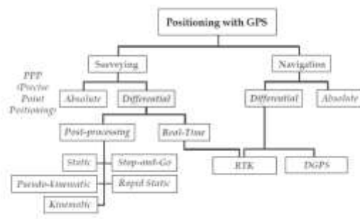
Gambar 1. Diagram Alir Penentuan Posisi dengan GNSS
