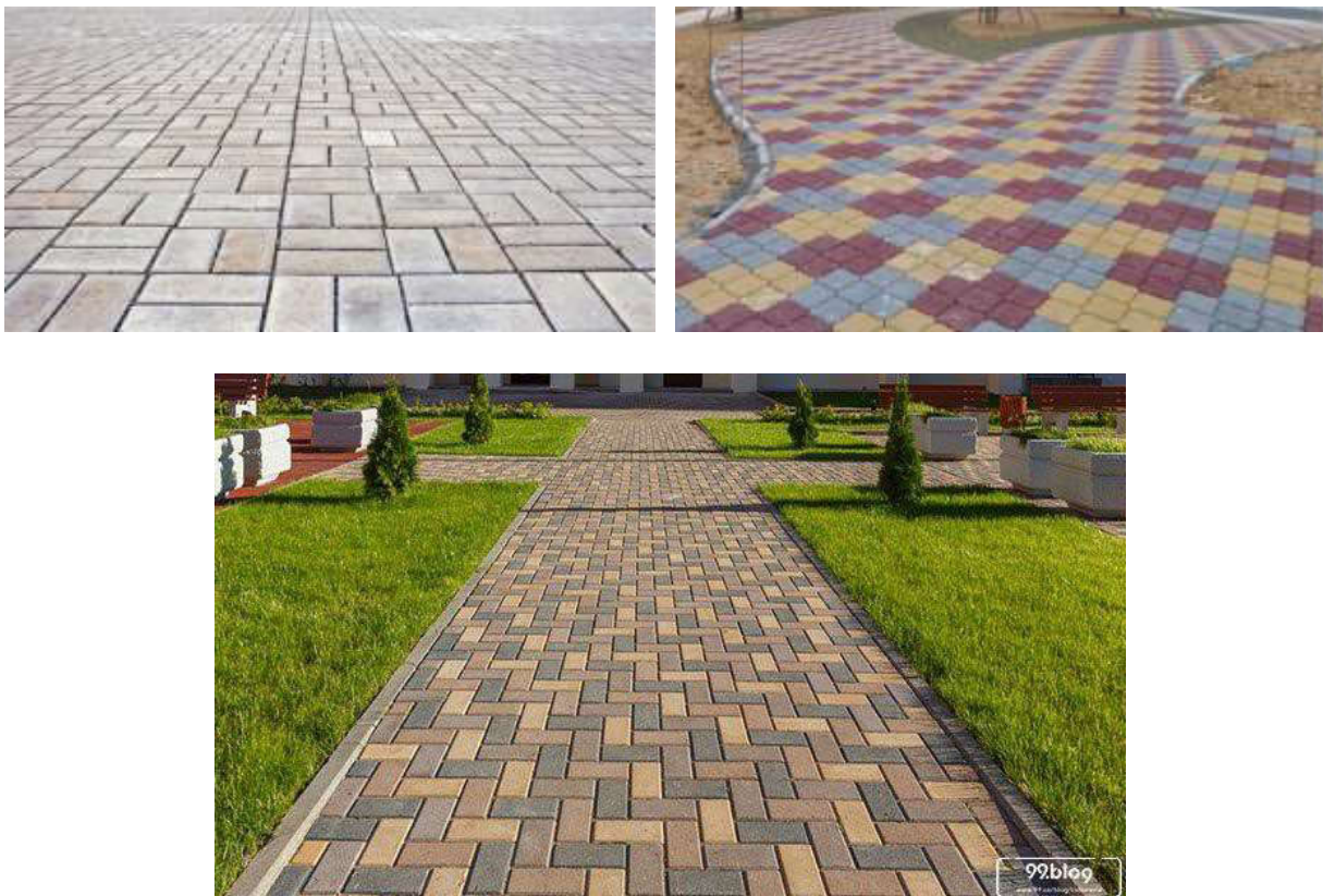
Gambar 6 Beberapa desain pemasangan paving blok
