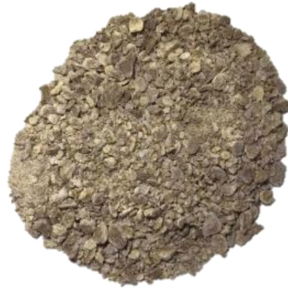
Gambar 2. Hasil penepungan menggunakan hammer mill .
