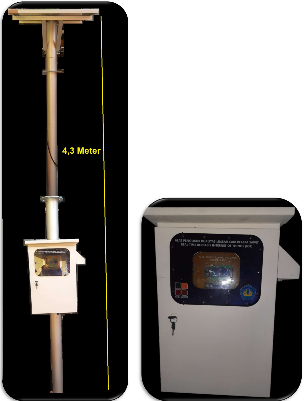
Gambar 4.1 Alat Deteksi Cepat Kualitas Air Limbah Pabrik Pengolahan Sawit Berbasis IoT
