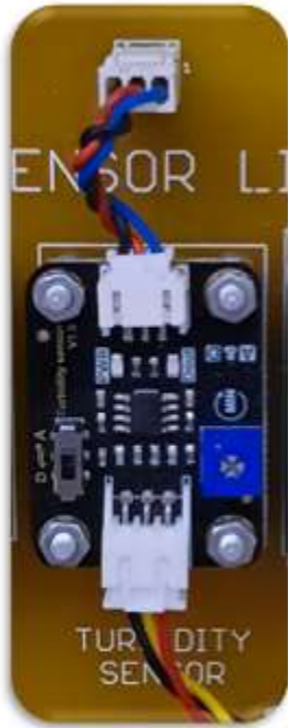
a. Modul Amplifier dan stabilizer Sensor Turbidity Limbah
