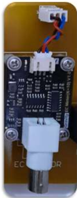
a. Modul Amplifier dan stabilizer Sensor EC Limbah
