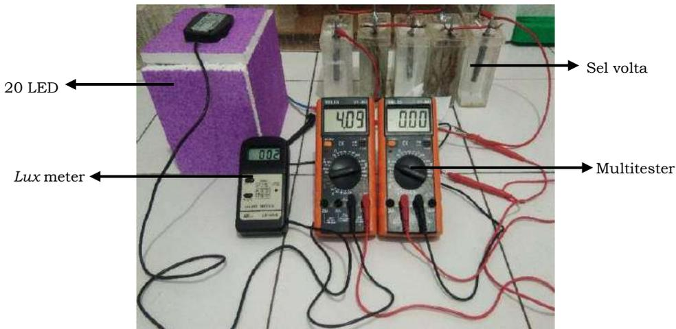
**Gambar 3.** Realisasi sistem sel volta
