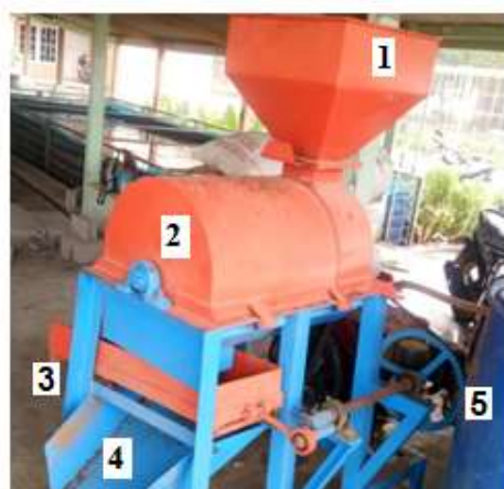
Gambar 1. Alat Penghancur Kotoran Kambing Tipe Basah
