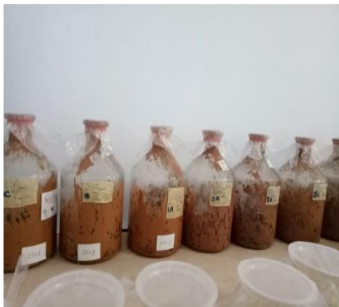
Gambar 5. Inkubasi Tanah dengan Biochar Inkubasi tanah dengan biochar dilakukan untuk mempelajari pengaruh waktu dan
