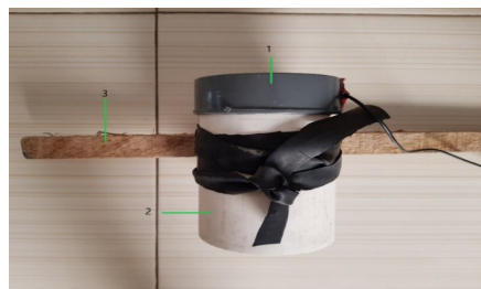
Gambar 8. Alat pasut sensor ultrasonik terbuka
