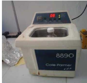
Gambar 2. Pembuatan biodiesel dengan bantuan gelombang ultrasonik
