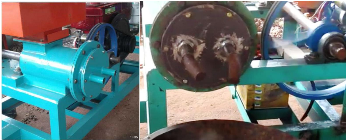
Gambar 5-22. Mesin pellet biomassa skala industri kecil, mesin 24 HP
