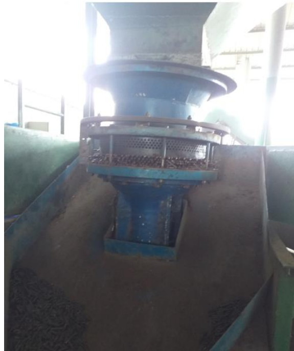
Gambar 5-4. Mesin pencetak pelet TKKS tipe vertical ring die .
