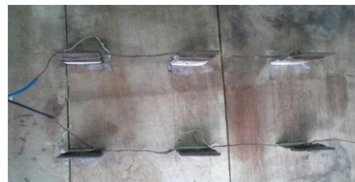
Gambar 2. Elektroda Fe susunan monopolar
