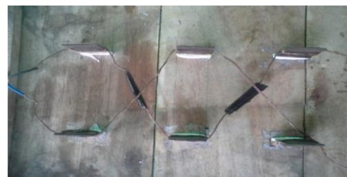
Gambar 3. Elektroda Fe susunan dipolar
