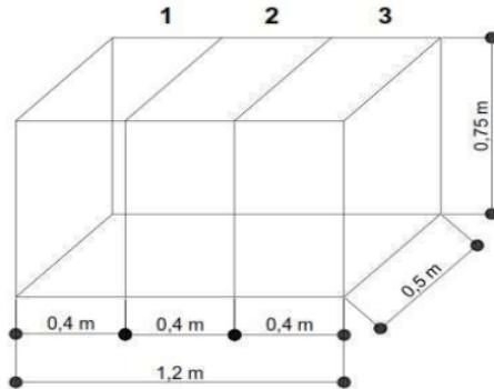
Gambar 1. Kotak Kaca untuk permodelan laboratorium
