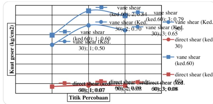
**Gambar 2.** Hasil pengujian kuat geser tanah tak jenuh
