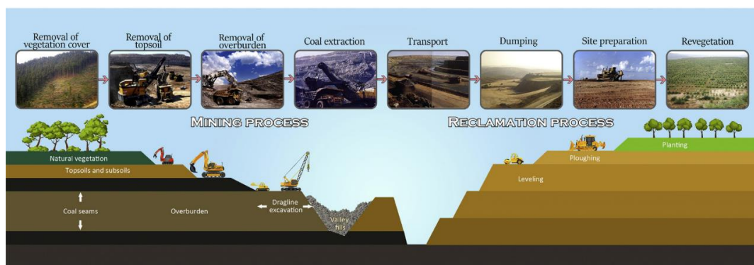
Gambar 3. Proses penambangan batu bara dan proses reklamasinya (Feng et al. , 2019)
