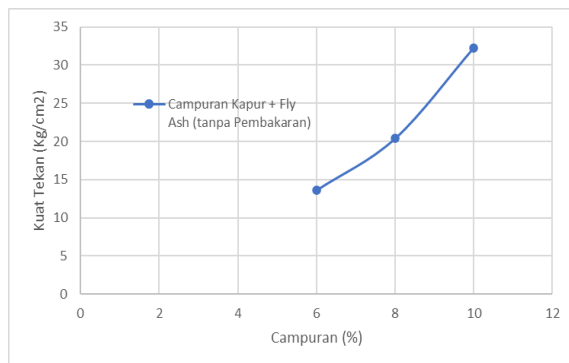
Gambar 2. Hubungan antara Nilai Kuat Tekan Paving Block tanpa pembakaran dengan kadar campuran Kapur + Fly Ash
