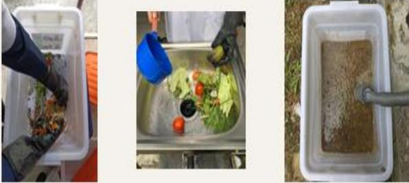
Penghancuran limbah makanan dan air yang telah ditimbang dengan mesin crusher, dilakukan perlakuan crushing untuk memperkecil ukuran dan memperluas permukaan substrat sehingga mudah kontak dengan bakteri atau inokulum
