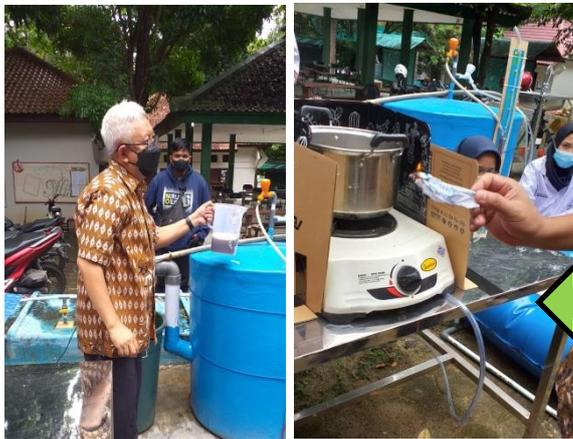
Praktek uji nyala api biogas dan pengambilan effluent biogas untuk digunakan sebagai pupuk cair
