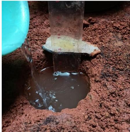
Gambar 7. Proses Test Permeabilitas Lapangan
