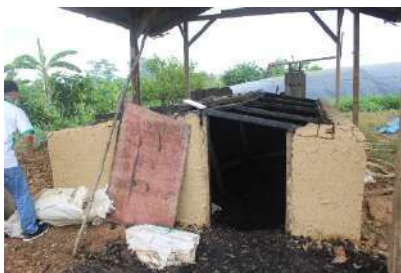
Gambar 1. Tungku yang dimodifikasi dengan membuatnya dari batu bata dan tanah liat.
