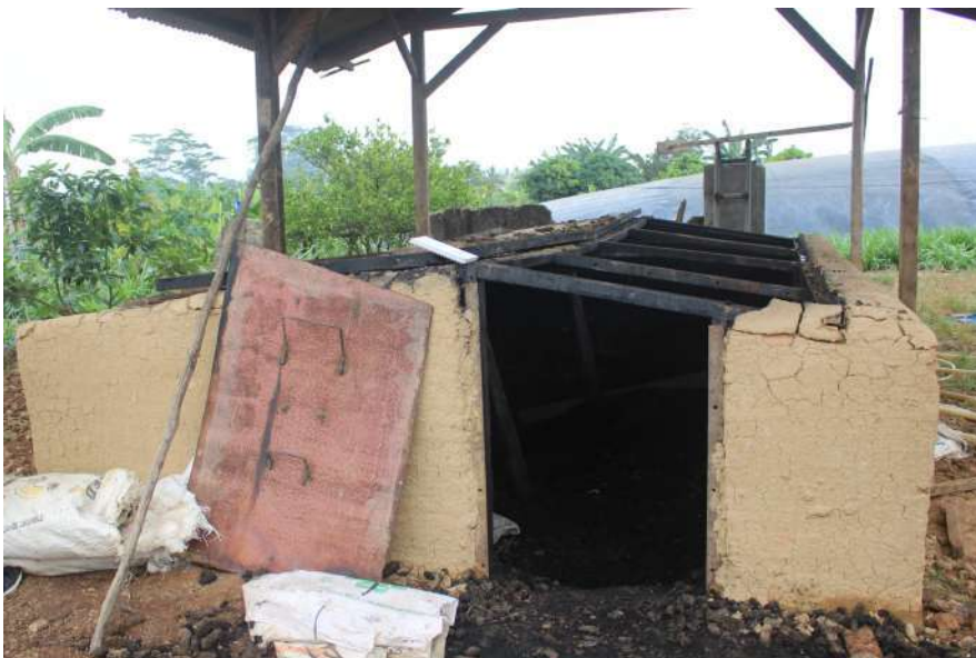
Gambar 4. Tungku modifikasi metode kon tiki yang dibuat dalam kegiatan PkM ini
