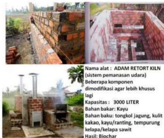
Gambar 3. Pirolisator model Adam Retort Kiln di KP Taman Bogo, Lampung
