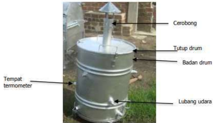
Gambar 1. Pirolisator terbuat dari drum
