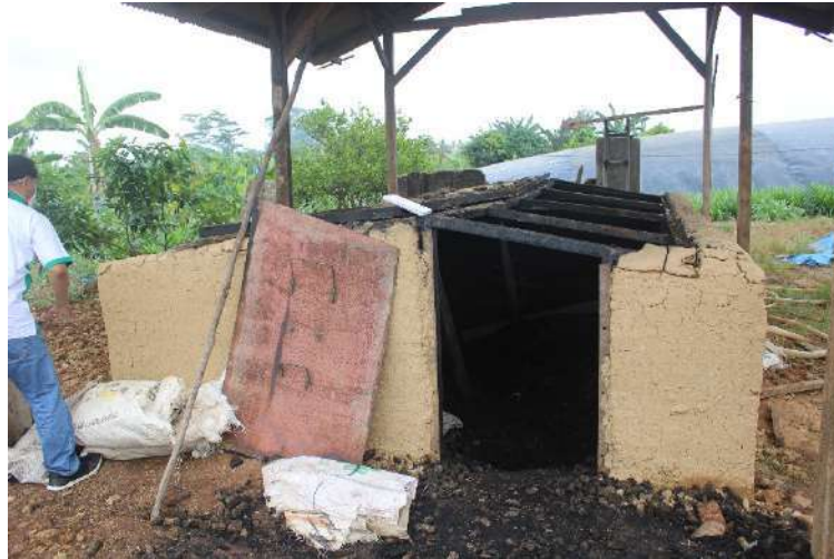
Gambar 2. Tungku kon tiki yang dimodifikasi dengan membuatnya dari batu bata dan tanah liat.
