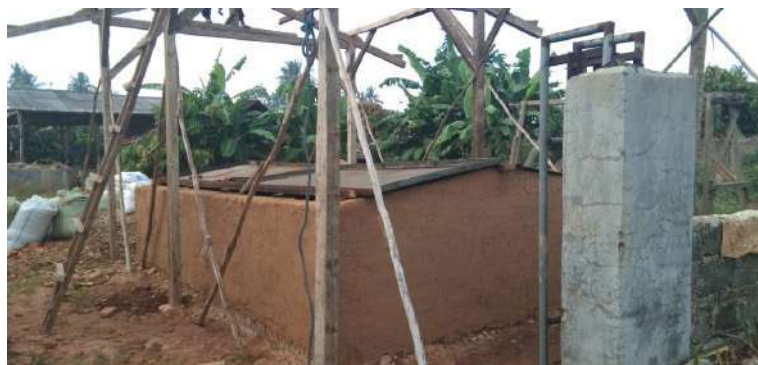
Gambar 11. Tungku pirolisis dengan metode Kon Tiki yang dimodifikasi.
