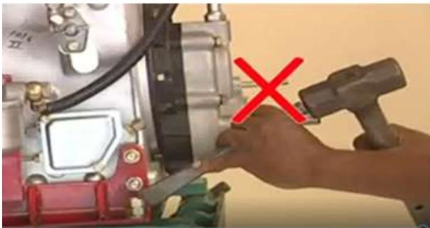
**Gambar 15.** Tidak menggunakan palu/martil (*hammer*) untuk membuka baut pondasi mesin
