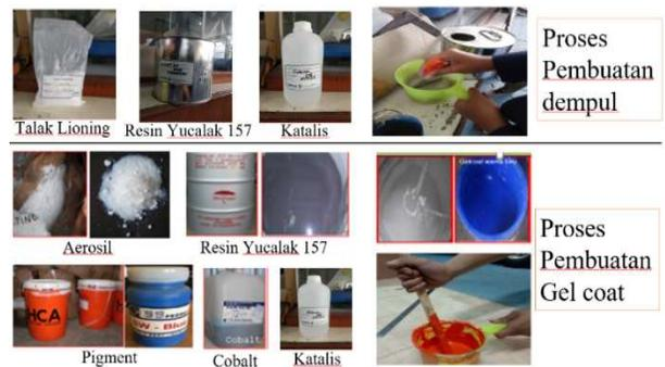
**Gambar 10.** Pembuatan dempul dan gel coat
