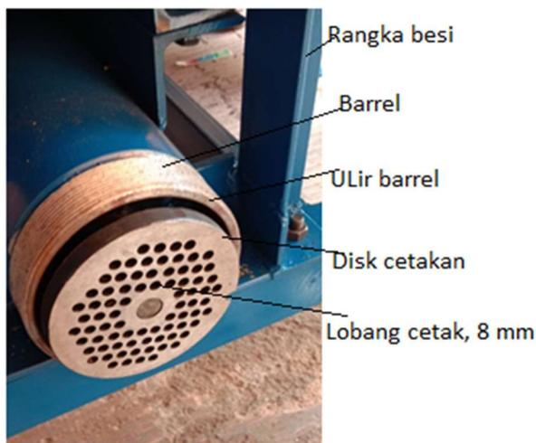
**Gambar 3.** Disk atau lempeng pencetak pellet berukuran diameter 10 mm
