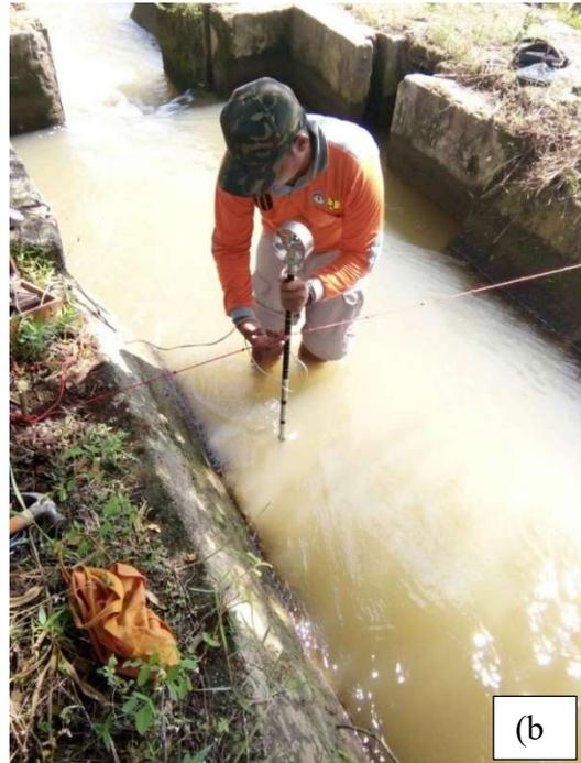
**Gambar 2.** Kegiatan yang dilakukan saat kalibrasi pintu air (a) mengatur bukaan pintu, ((b) mengukur aliran di saluran
