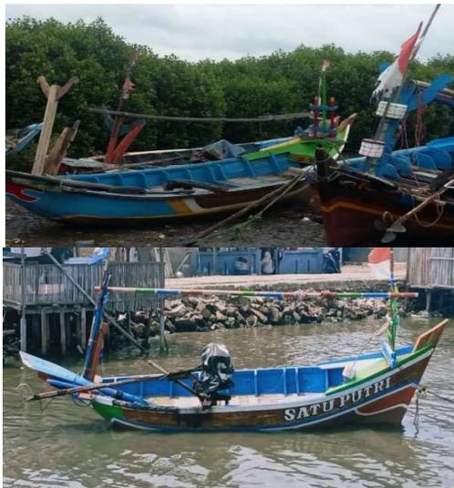
**Gambar 1.** Perahu ikan kayu menggunakan mesin tempel tipe *long shaft*
