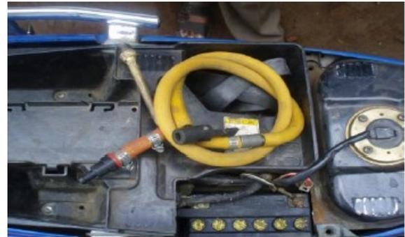
**Gambar 2.** Alat kompresor udara mini dalam bagasi sepeda motor
