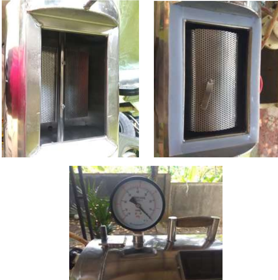
Gambar 5. Penambahan rubber seal dan penggantian manometer.
