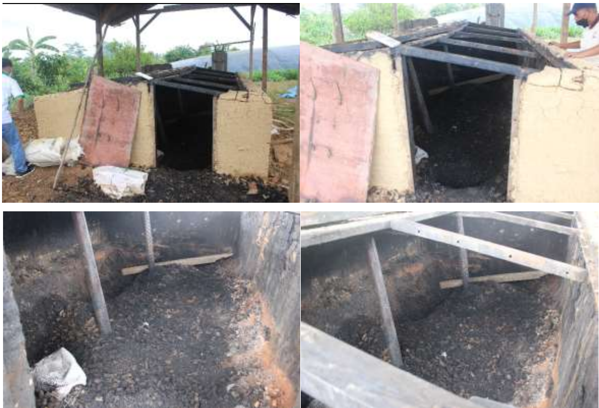
Gambar 4. Kiln (tungku) pirolisis tongkol jagung
