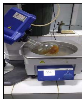
Gambar 3.(c). Proses pengentalan ekstrak biji dengan rotary evaporator
