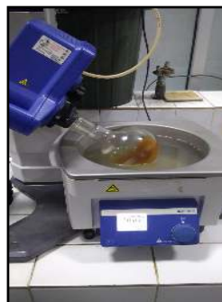
Gambar 3.(b). Proses pengentalan fraksi biji dengan rotary evaporator
