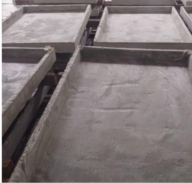
Gambar 33. Panel ferosemen yang dicetak
