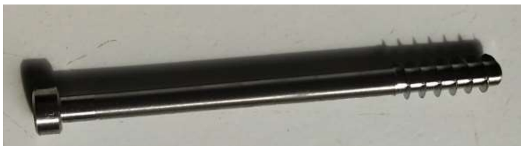
Gambar 15. Baut ulir kortikal dari bahan titanium paduan (Ti-6Al-4V ELI)
