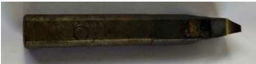
Gambar 16. Pahat karbida yang digunakan untuk memotong paduan titanium
