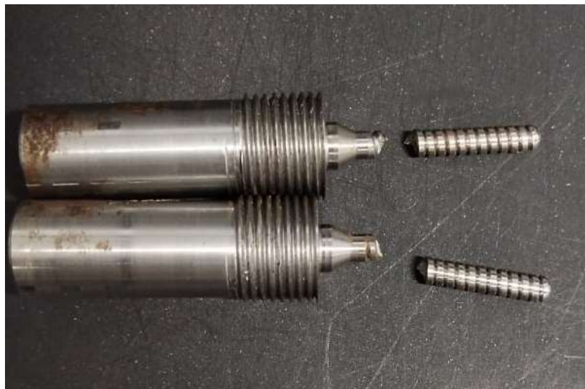
Gambar 13. Ulir magnesium mengalami patah karena magnesium bersifat getas dan berpori serta dengan dimensi diameter yang kecil
