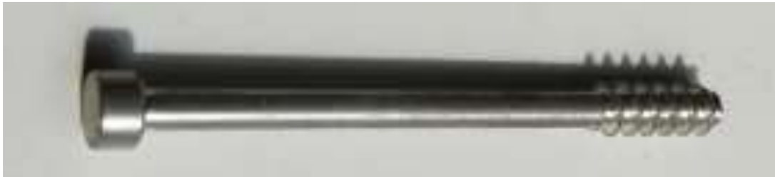
Gambar 14. Baut ulir implant dari material magnesium
