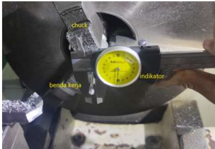
Gambar 12. Pembubutan dilakukan secara bertahap dan dilakukan pengukuran
