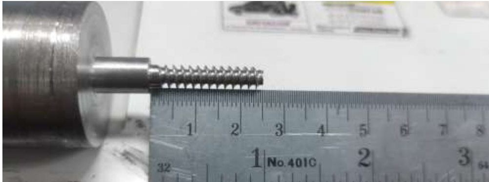
Gambar 11. Ulir magnesium yang dihasilkan menggunakan pahat ulir dengan tipe
