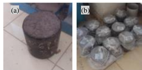
Gambar 3. Benda uji, (a) selesai dipadatkan, (b) proses pemeraman
