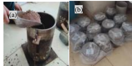
Gambar 2. Pengujian CBR, (a) pembuatan benda uji, (b) benda uji yang sedang diperam
