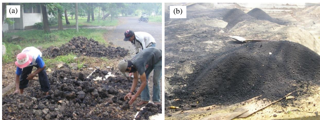
Gambar 1. Material aspal Buton (a) berbentuk bongkahan, dan (b) setelah dihaluskan
