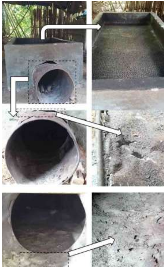
Gbr. 1 Foto makroskopik kondisi real tungku pengering kakao konvensional
