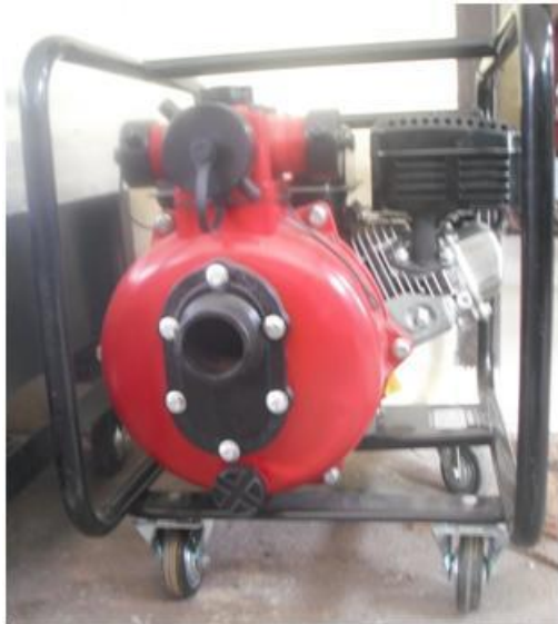
Gambar 6 Pompa dan Tenaga Penggerak
