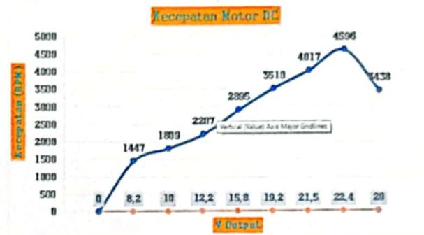
Gambar 4.3 Grafik Hubungan Tegangan dengan Putaran
