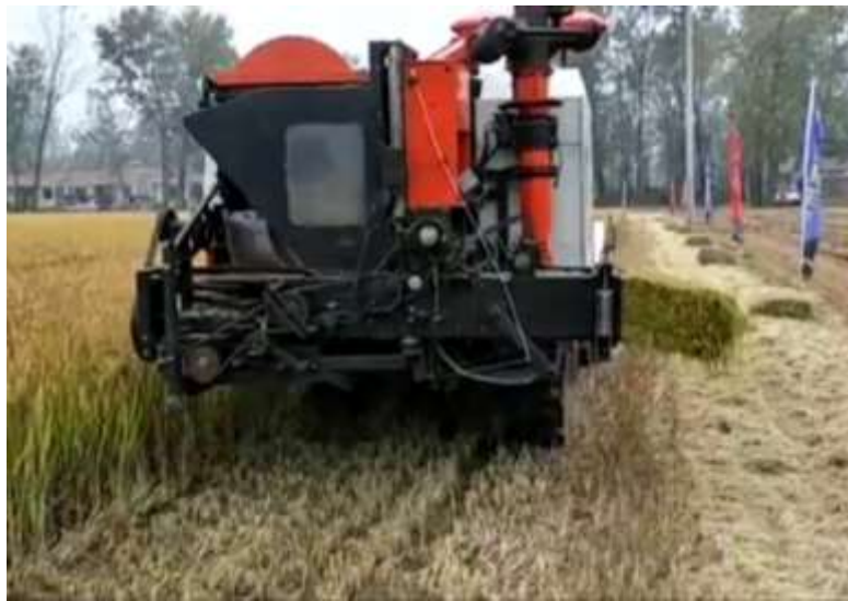
Gambar 3. Sebuah mesin pemanen padi combine harvester-baler ( www.youtube.com )
