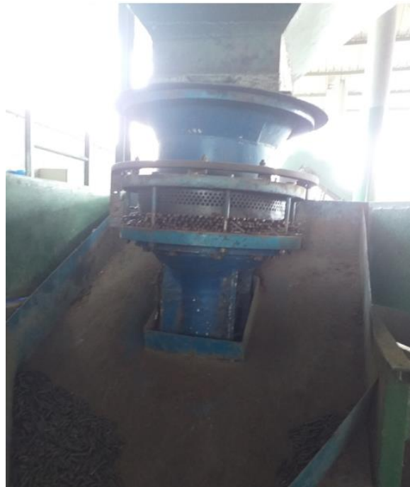
Gambar 5-4. Mesin pencetak pelet TKKS tipe vertical ring die .
