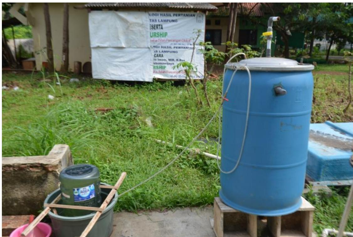
Gambar 13. Rangkaian penelitian produksi biogas dari TKKS melalui proses fermentasi kering
